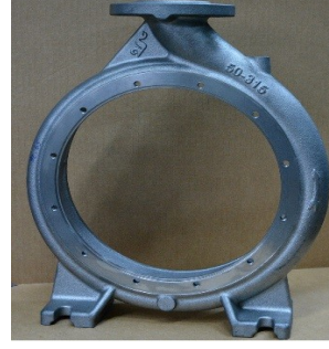
Şekil 17. Akrilik salyangoz kapağı ve ön yüzeyi çıkarılmış salyangoz.
