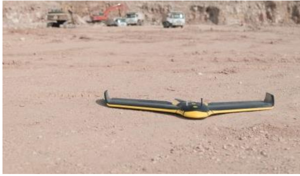
Resim 13: Sabit kanatlı insansız hava araçları, daha büyük, daha geniş şantiyelerin haritasını çıkarmak için kullanılıyor
