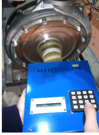
Şekil 22. Çark kanatlarının stroboskopik ışık kaynağı kullanarak bağlı olarak hareketsiz şekilde görüntülenmesi.
