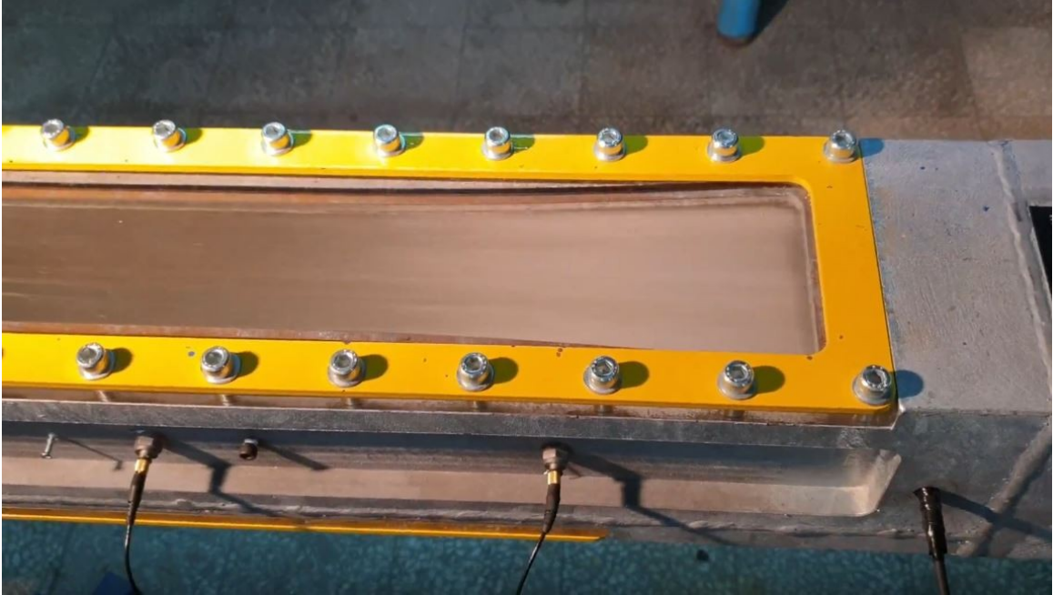
Şekil 10. Kuvvetli kavitasyon durumunda lüledeki akışın görünümü.
