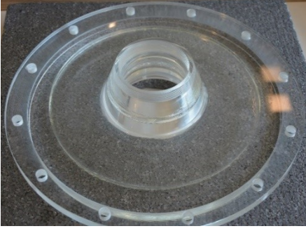
Şekil 17. Akrilik salyangoz kapağı ve ön yüzeyi çıkarılmış salyangoz.
