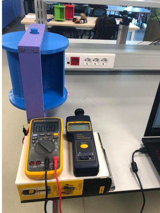
Görsel 4 - Deney Düzeneği (Çerçeve, Takometre ve Multimetre)
